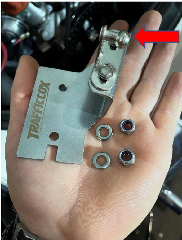
Installer les fixations de vérins avec les crochez vers le haut et intérieur du capot.
