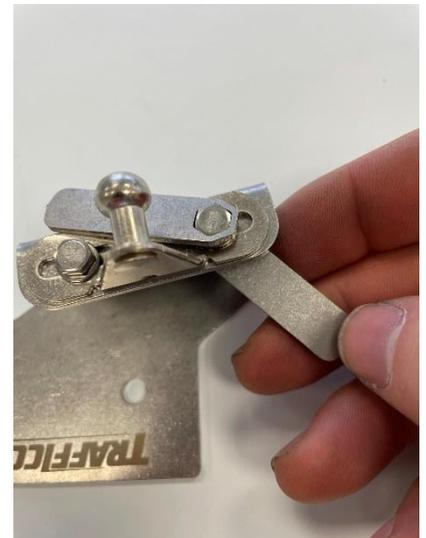
**Sachet numéro 2**, vis et rondelles sur le dessus, rondelles fendu et écrous en dessous, régler au centre et serré.
